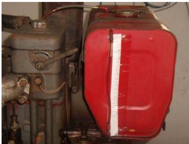
Figura 38 – Medidor de nível de combustível para gerador a diesel.
