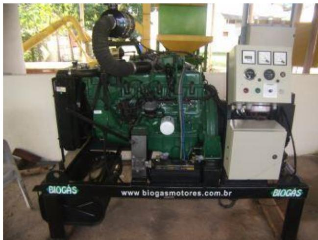
Figura 28 – Gerador trifásico com o motor movido a etanol.
