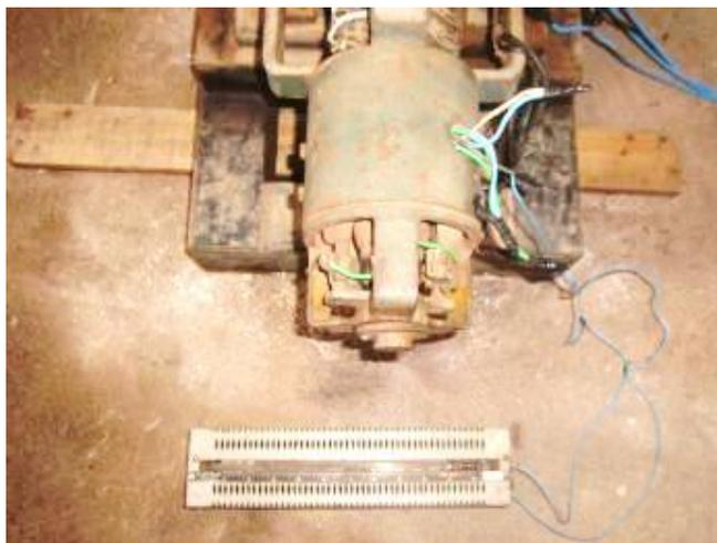
Figura 39 – Excitatriz Shunt acoplada ao gerador.
