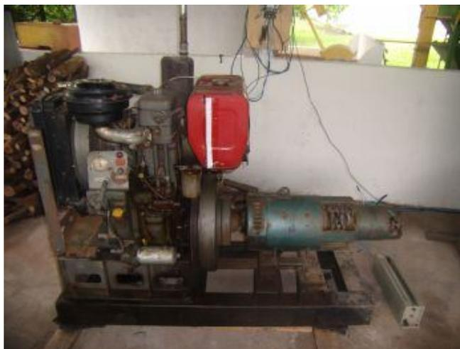
Figura 37 – Gerador trifásico com motor movido a diesel.
