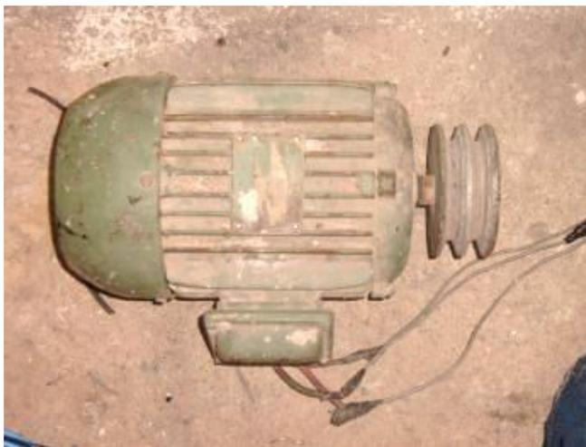
Figura 35 – Motor trifásico de 1,5 cv.
