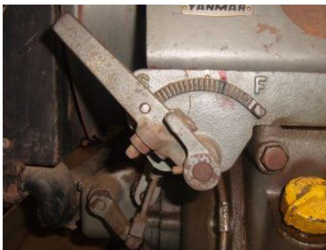
Figura 40 – Acelerador manual do sistema à diesel.
