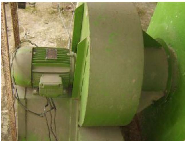
Figura 36 – Motor trifásico de 5 cv.
