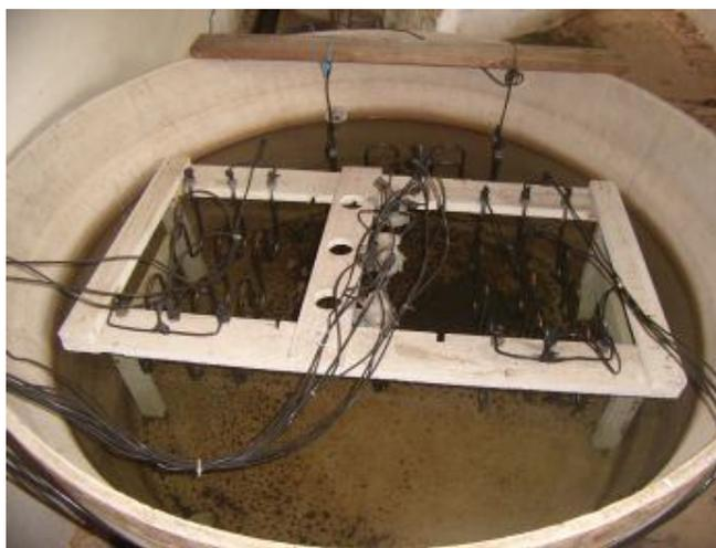
Figura 22 – Conjunto para dissipação da energia do gerador.
