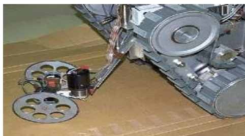
Figura 6: Encoder auxiliar, desenvolvido pela Universidade de Michigan para uso conjunto com o robô Andros V
