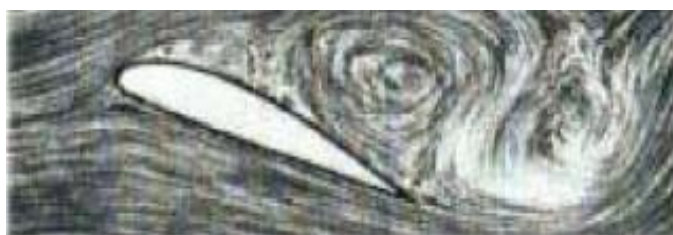
Figura 9 – Pá de hélice controlada por Estol
