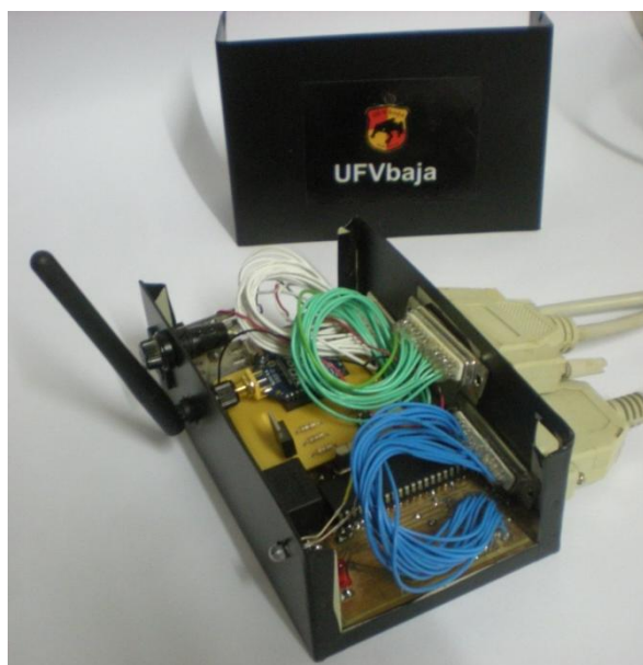
Figura 15 - Fotografia da central de processamento de dados e da telemetria
