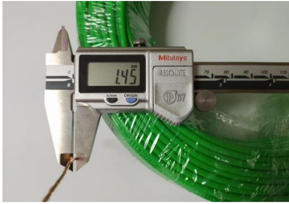
Figura 2. Medição do condutor de cobre de cabo flexível 2,5 mm² do Fabricante A: leitura de 1,45 mm, inferior ao limite mínimo de 1,80 mm.
