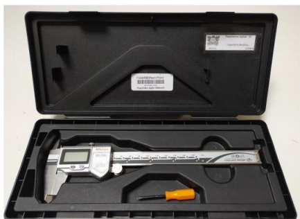
Figura 1. Paquímetro digital utilizado nas medições dimensionais dos cabos.
