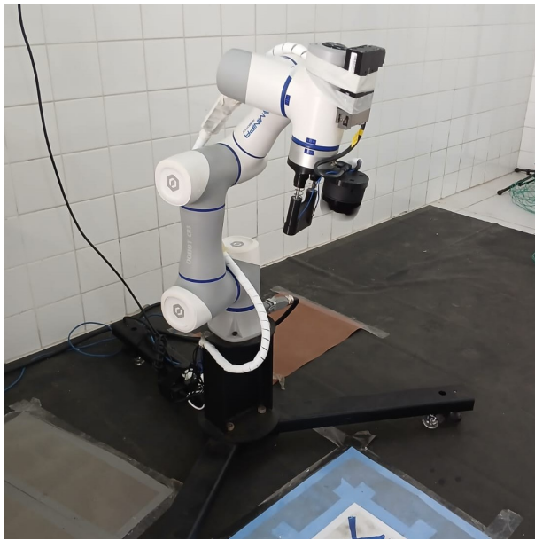
Figura 2: O cobot Dobot CR3, manipulador serial de seis graus de liberdade utilizado neste trabalho, com a garra magnética (eletroímã) montada no flange.
