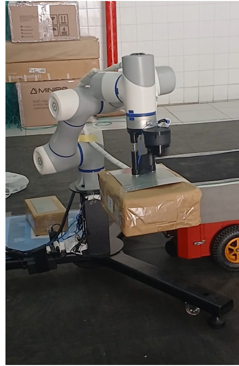
Figura 5: Demonstração de pick-and-place no robô real: o CR3 segura a caixa pela chapa metálica superior com a garra magnética (eletroímã), conduzido por teleoperação gestual com a prevenção de singularidade e de colisão ativas.
