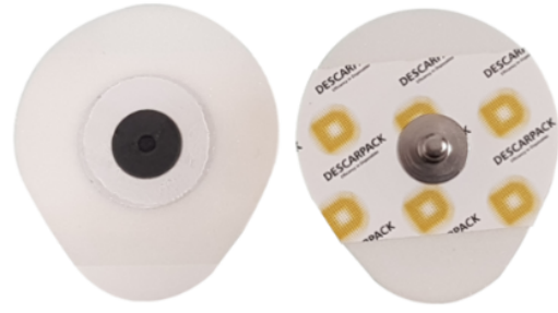
Figura 3: Vista frontal e traseira de um eletrodo descartável para ECG respectivamente. Eletrodo autoadesivo descartável para uso adulto, modelo tipo “pêra”, utilizado na aquisição de sinais eletrofisiológicos, como o eletrocardiograma (ECG). A parte traseira contém o conector metálico para ligação ao cabo do equipamento, enquanto a vista frontal possui a superfície adesiva e condutora em gel, que é aplicada diretamente sobre a pele do paciente. Fonte: Adaptado de [20].
