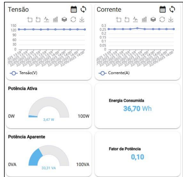
Fig.20 Geladeira ligada no nível de temperatura médio, após 2:20 h de funcionamento, com o compressor desligado. Fonte: Autor.
