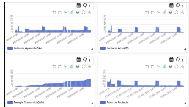
Fig.21 Geladeira ligada no nível de temperatura médio, após 6 h de funcionamento. Fonte: Autor.
