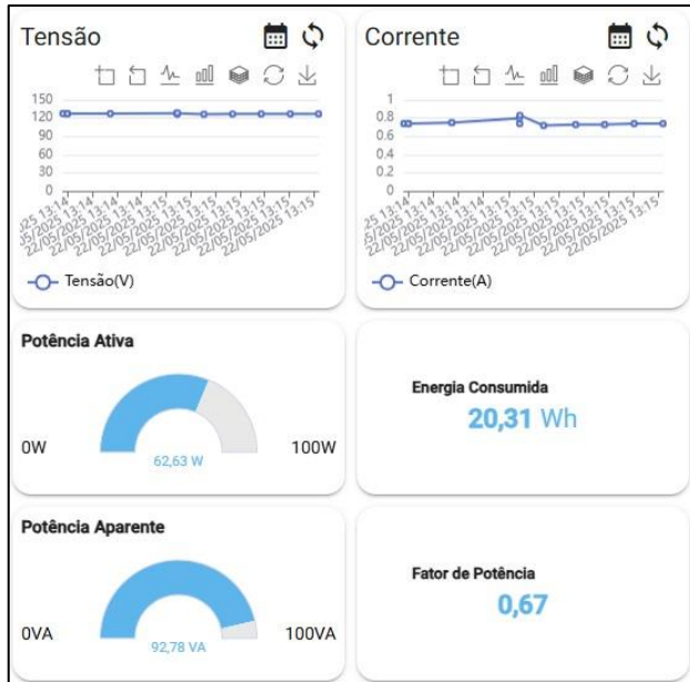
Fig.18 Geladeira ligada no nível de temperatura ajustado para máximo, após 1:35 h de funcionamento, com compressor ligado. Fonte: Autor.
