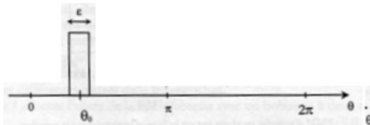
Figura 1-11 - Função  $j(\theta_{ele})$  de um só slot
