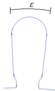
Figura 1-10 - Representação de um slot e sua abertura angular
