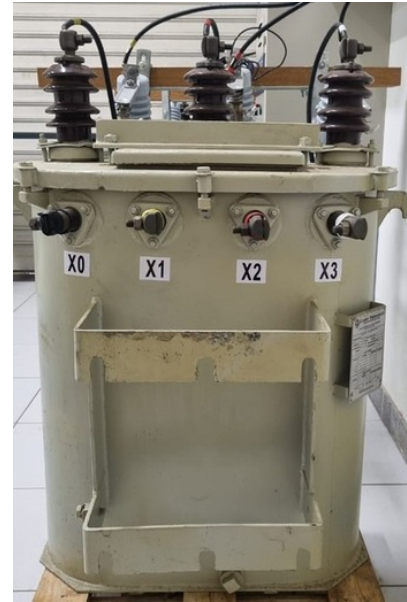
Figura 4. Transformadores de Distribuição
