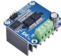
Figura 3.7 – Placa para controle de velocidade dos motores CC 400W [8].
