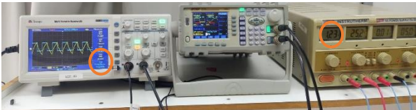
Figura 4.4 – Frequência 500 Hz , I_{in} = 1,23 A
