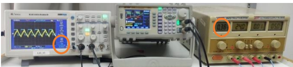
Figura 4.6 – Frequência 5.000 Hz , I_{in} = 0,38 A
