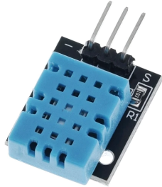
Fig. 4. Módulo com sensor de temperatura e umidade DHT 11 integrado. Fonte: [27].
