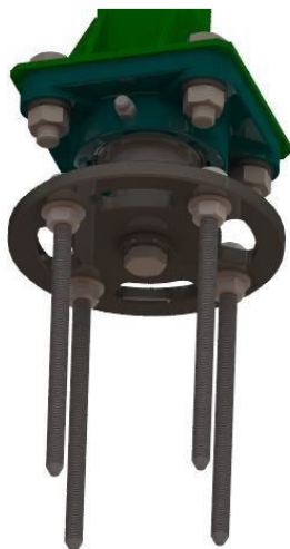
Figura 8: Modelo do rotor de hastes utilizado no trabalho
