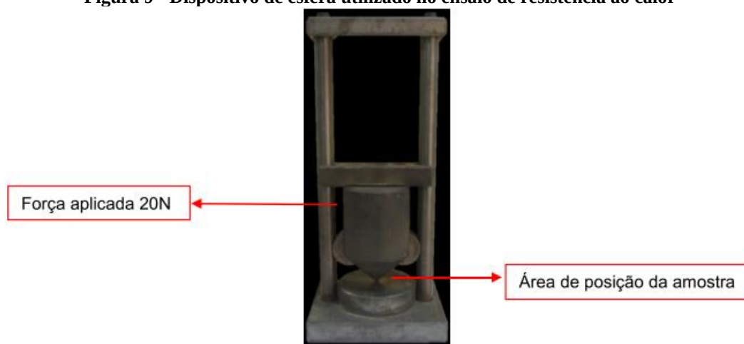
Figura 9 - Dispositivo de esfera utilizado no ensaio de resistência ao calor
