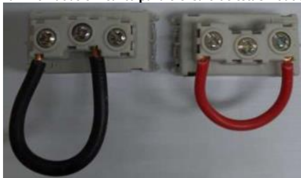
Figura 10 – Tomadas em curto para o ensaio de estabilidade térmica
