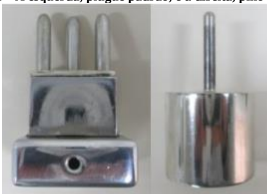
Figura 12 – À esquerda, plugue padrão, e à direita, pino calibrador
