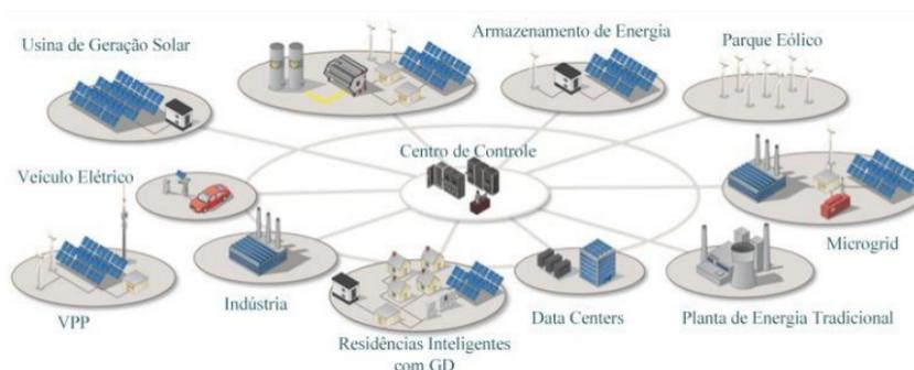
Figura 4 – Rede elétrica com geração distribuída.
