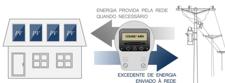
Figura 9 – Medição bidirecional em sistemas SFCR.
