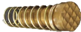
Figura 2.6: Contato utilizado pelo dispositivo pneumático em auxílio ao sistema de medição da ponte RLC
