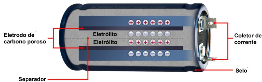
Figura 5 – Componentes internos do ultracapacitor da empresa *LS Materials*. Fonte: Adaptado de (MATERIALS, 2022)
