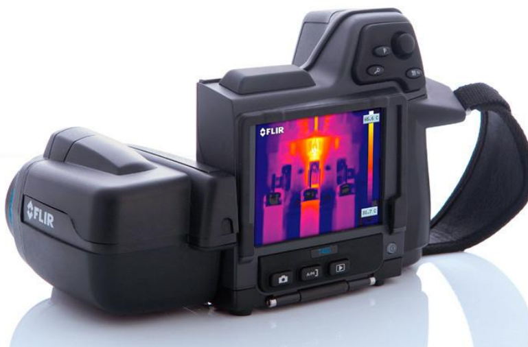
Figura 3.2: Câmera Termográfica FLIR T420
