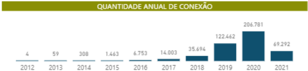
Figura 1 - Quantidade anual de conexões de unidades geradoras de até 5.000kW no Brasil
