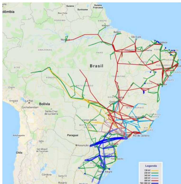
Figura 5 - Linhas de transmissão de alta tensão no Brasil (SINDAT, 2020).
