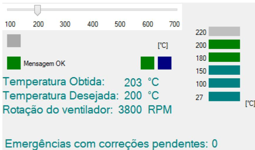
Figura 10. Display de informações instantâneas do supervisório e barra de ajuste da temperatura desejada.
