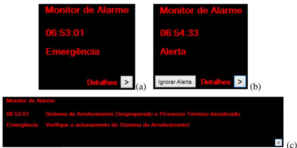
Figura 7. Tela do monitor de alarmes (a) em um caso de emergência, (b) em um caso de alerta e (c) com a descrição detalhada de uma emergência.
