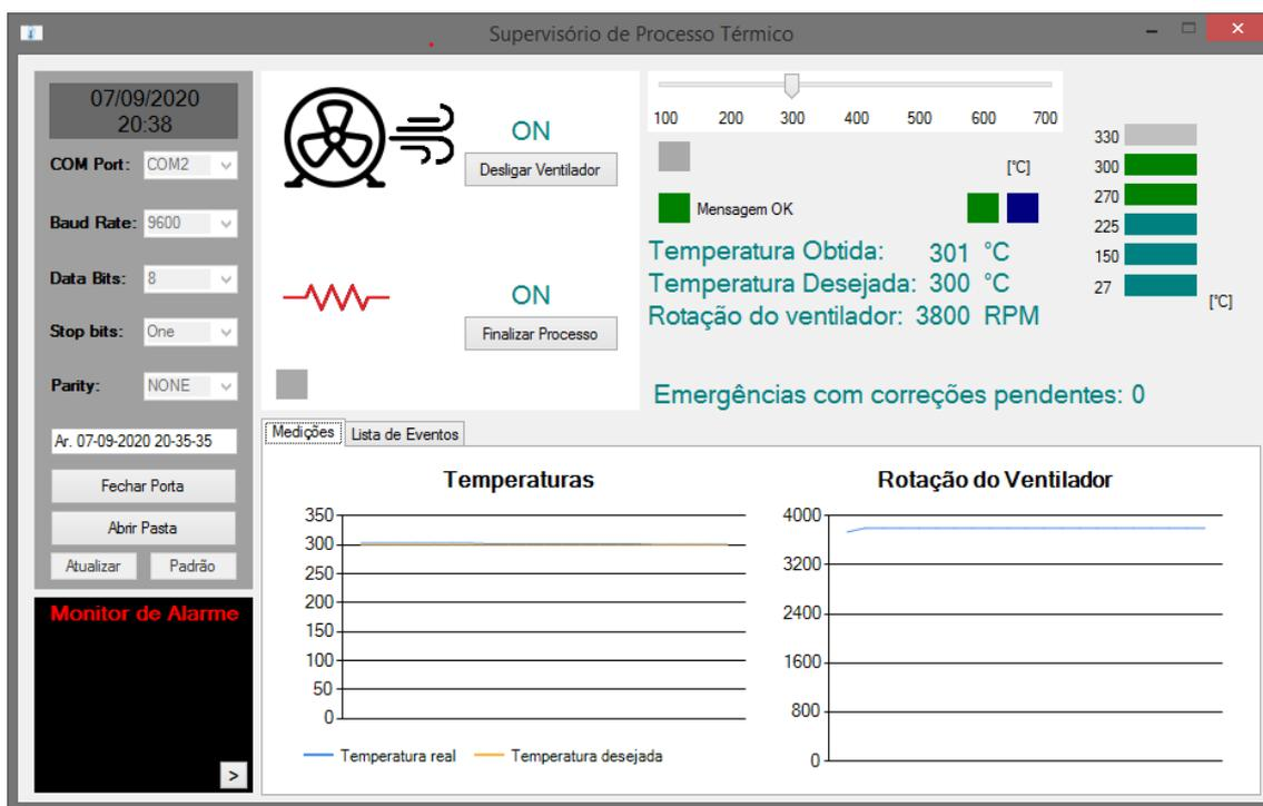
Figura 13. Sistema supervisorío operando durante as simulações (temperatura desejada ajustada para 300 °C).
