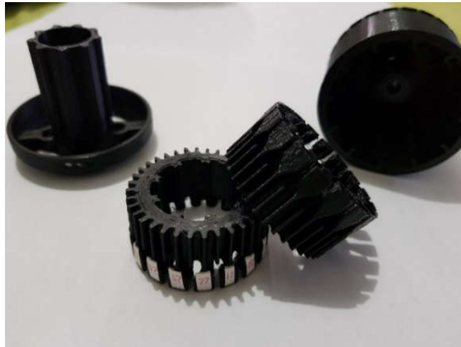
Figura 16 - Partes impressas da máquina síncrona: escudo do estator (à esquerda), núcleo do estator (ao centro) e rotor (à direita).
