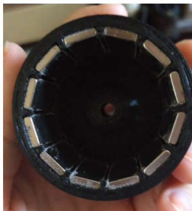
Figura 19 - Rotor da máquina síncrona, com os ímãs devidamente alocados.
