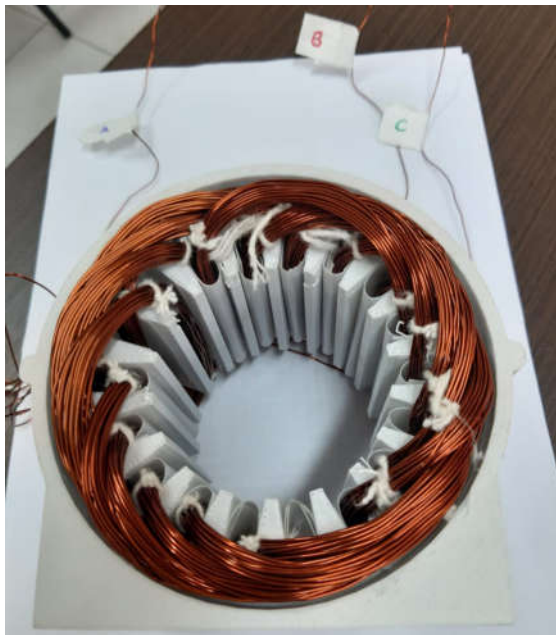
Figura 24 - Estator da máquina de indução com os devidos enrolamentos trifásicos.
