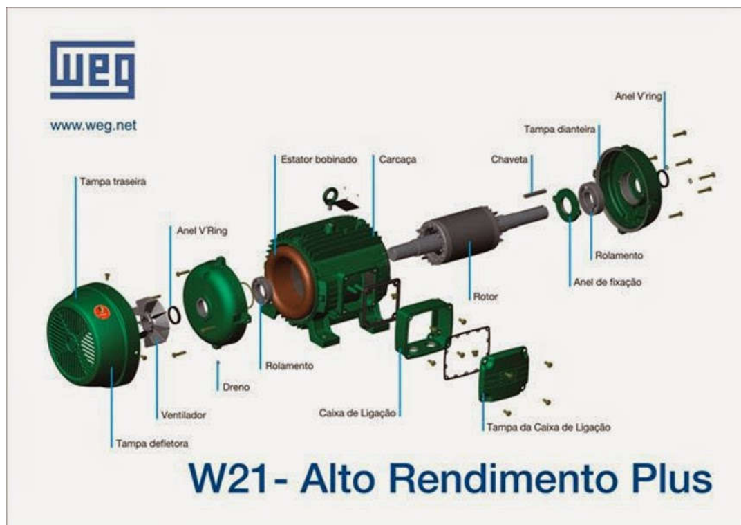
Figura 6 - Vista explodida de um motor de indução da WEG [6].
