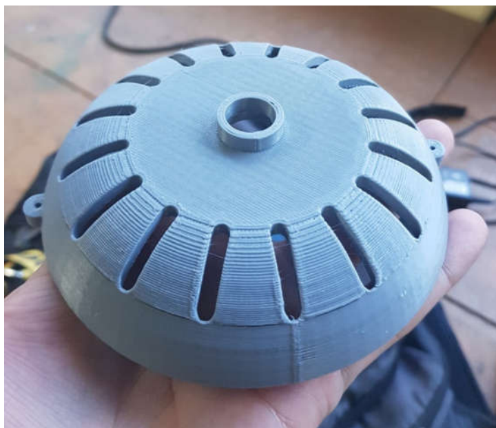
Figura 25 - Tampa do estator da máquina de indução impresso em ABS.
