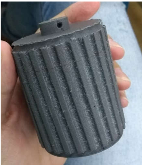
Figura 26 - Rotor da máquina de indução impresso em PLA magnético.
