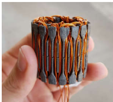
Figura 18 - Estator da máquina síncrona impresso em PLA magnético, com enrolamento em fio de cobre esmaltado.
