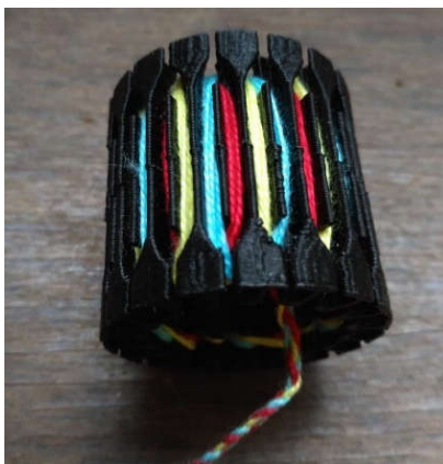
Figura 17 – Protótipo de estator da máquina síncrona, com enrolamento feito em linhas de crochê.
