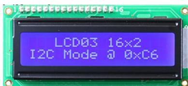
Figura 14 - Módulo *display* LCD.
