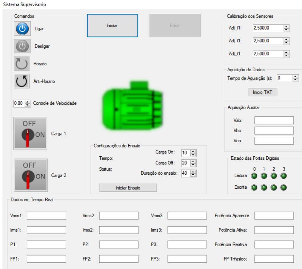
Figura 18 – Tela principal do software supervisorio e de aquisição de dados.
