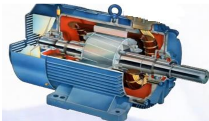
Figura 1.3 – Gerador de energia elétrica (CHAPMAN,2012)
