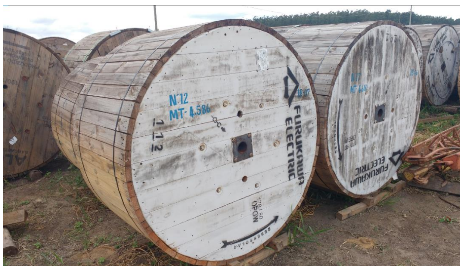
Figura 2.13 – Bobinas fibra OPGW (ENGELMIG ENERGIA,2018)
