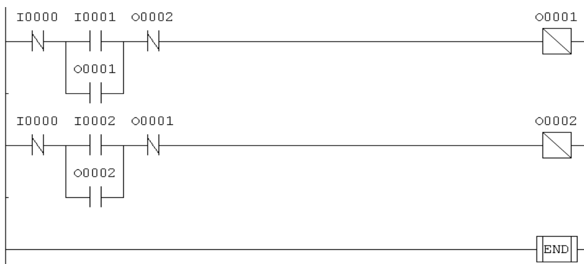
Figura 12 - Exemplo: Circuito de Intertravamento em LADDER (EUÍPEDES, 25/01/2019).
