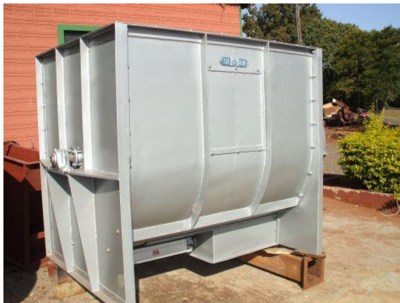
Figura 29 - Exemplo: Misturador Helicoidal – Peso Máximo 1000kg (AGRIFORTE, 25/01/2019).
