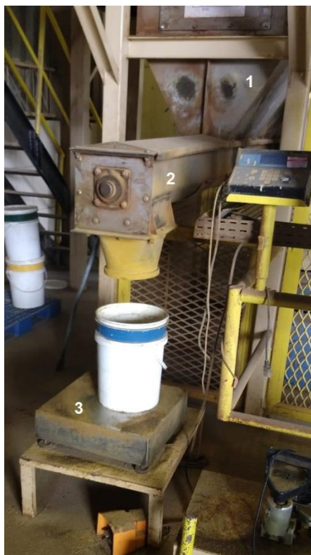
Figura 30 - Pulmão (1), Rosca Dosadora (2) e Balança de Ensacamento (3) (Acervo do Autor).
