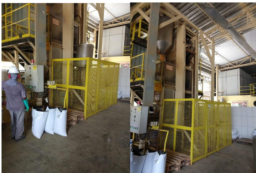
Figura 21 - Acionamento do Elevador Skip e Despejo do Produto no Misturador (Acervo do Autor).
