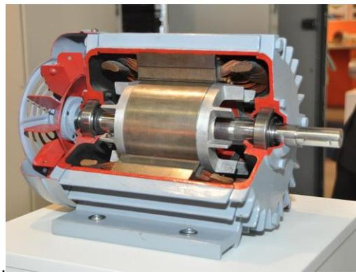
Figura 14 - Corte em um motor de indução gaiola de esquilo (Waard, 2011).
