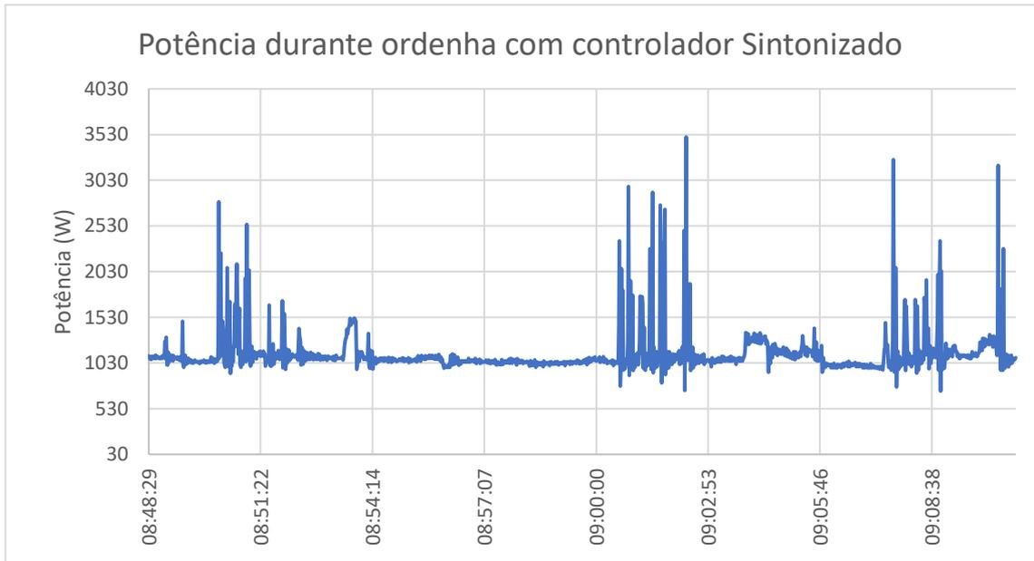
Figura 54 - Potência durante ordenha com controlador devidamente sintonizado.
