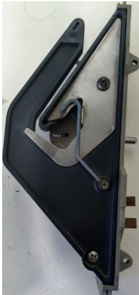
Figura 10-Lamela, o fio quando está correndo faz a trava ficar na posição mostrada.
