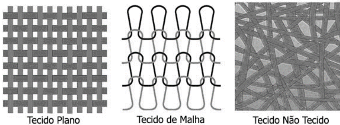
Figura 1- Tecido Plano, Tecido de Malha e Tecido Não Tecido
