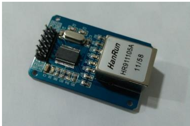
Figura 19- Módulo Ethernet (ENC28J60).
