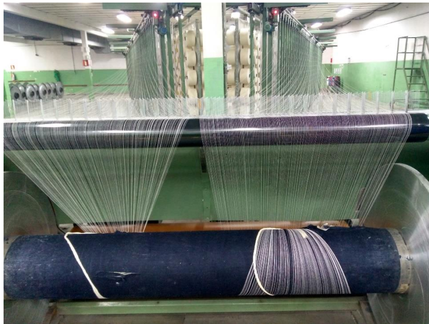
Figura 16 - Rolo de urdume no início do processo de urdimento.
