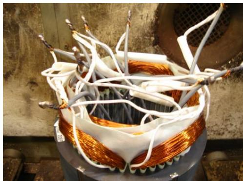
Figura 2.26 – Estator exposto para a identificação de terminais [16].
