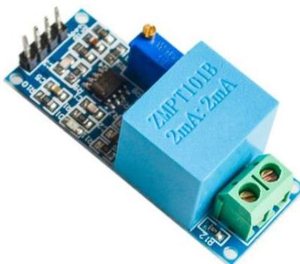
Figura 3.6 – Sensor de tensão ZMPT101b.
