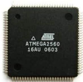
Figura 3.3 – Microprocessador ATMEGA 2560 com encapsulamento TQFP [29].
