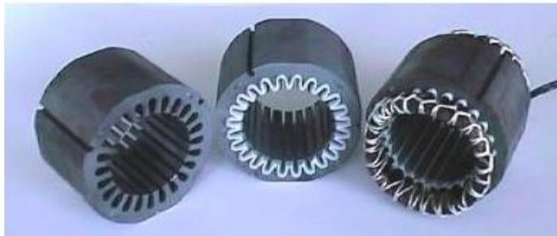
Figura 2.1 – Estatores em diferentes etapas no processo de fabricação [7].
