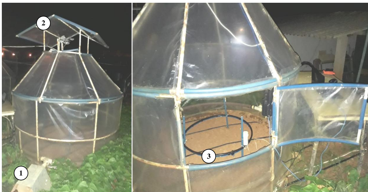
Figura 8 – A câmara de topo abero utilizada nos testes. 1) Um dos dois ventiladores externos; 2) Campânula para proteger da chuva; 3) Coletor circular de gás.
