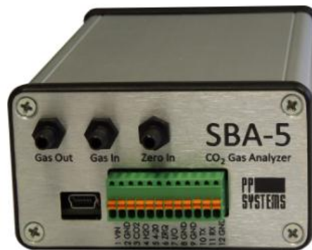
Figura 11 – Analisador de CO 2 por infravermelho SBA-5, com invólucro AGA407, o qual é substituído pelo sensor de CO 2 e pela bomba amostradora no sistema de controle alternativo.
