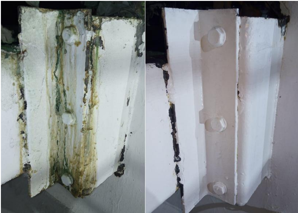
Figura 17 - Estrutura da malha do extrator de rótulos. Antes e depois do Dia D.
