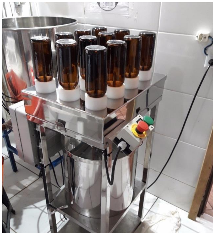
Figura 3 - Lavadora de garrafas de pequeno porte com capacidade de 12 vasilhames (Anon., 2018).
