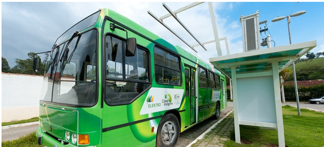
Figura 10 - Ônibus elétrico na base de carregamento do projeto (ELEKTRO).
