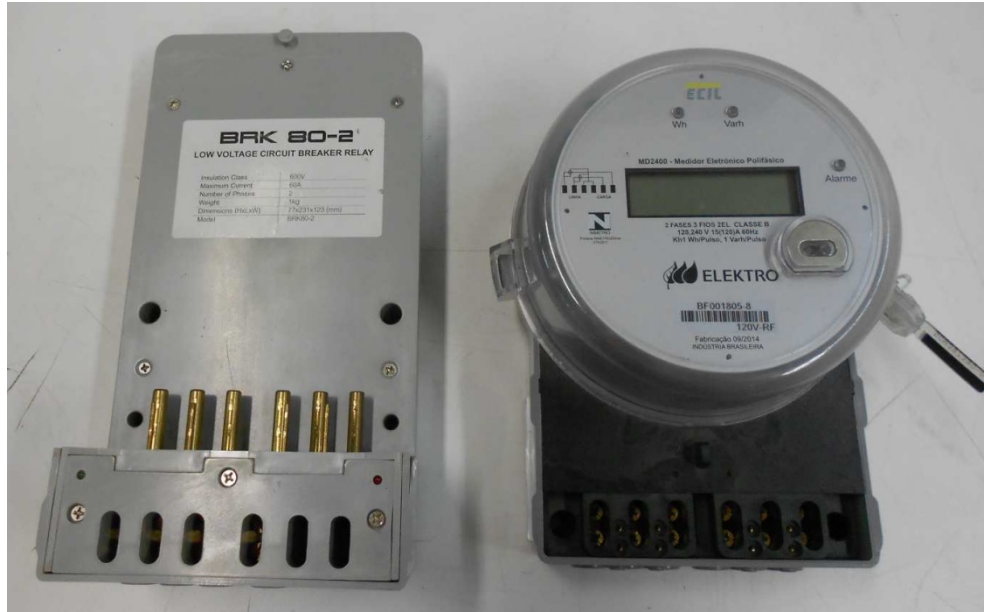
Figura 14 - À esquerda: a base de comunicação, à direita: o medidor. O conjunto corresponde ao medidor inteligente RF.
