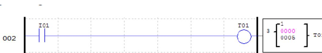
Figura 9 – Bloco de função temporizador no ladder (WEG, 2010).
