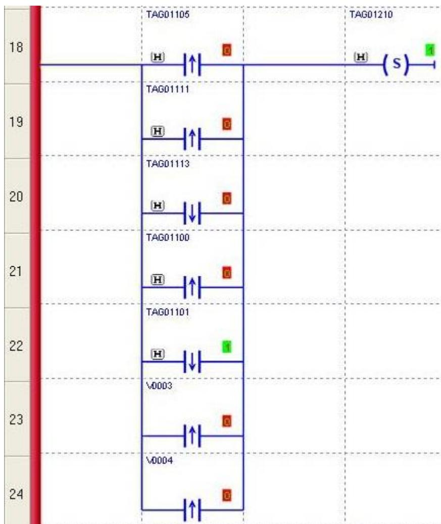
Figura 30 - Emergência ativando a sirene.
