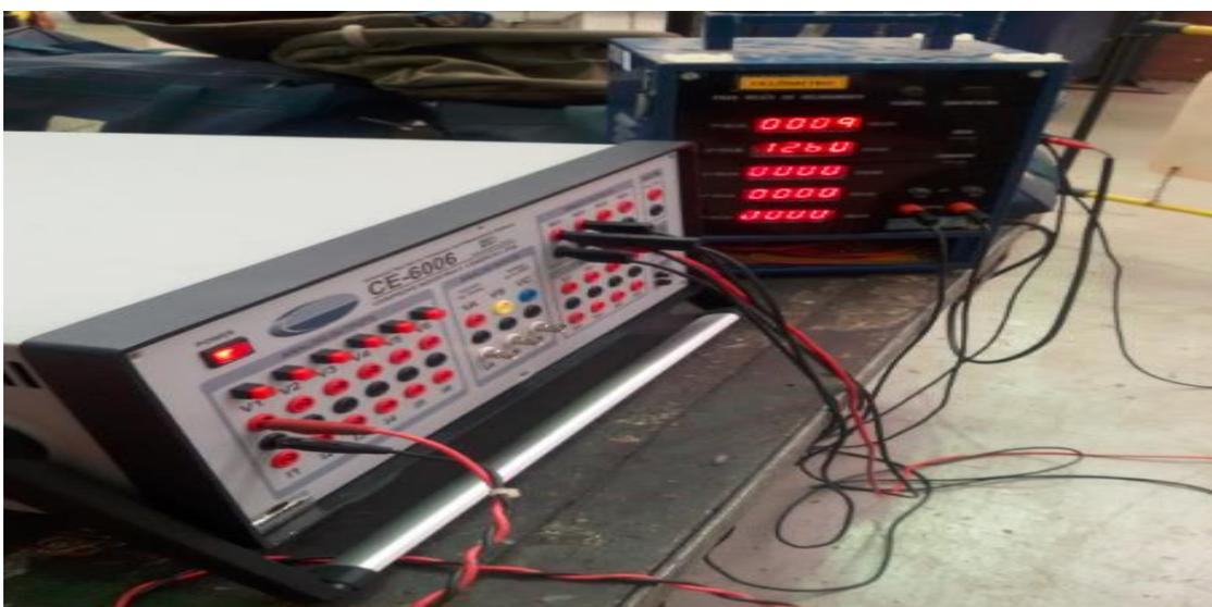
Figura 16. Imagem de uma caixa de geração CONPROVE CE006 e um ciclomêtro utilizado no ensaio.
