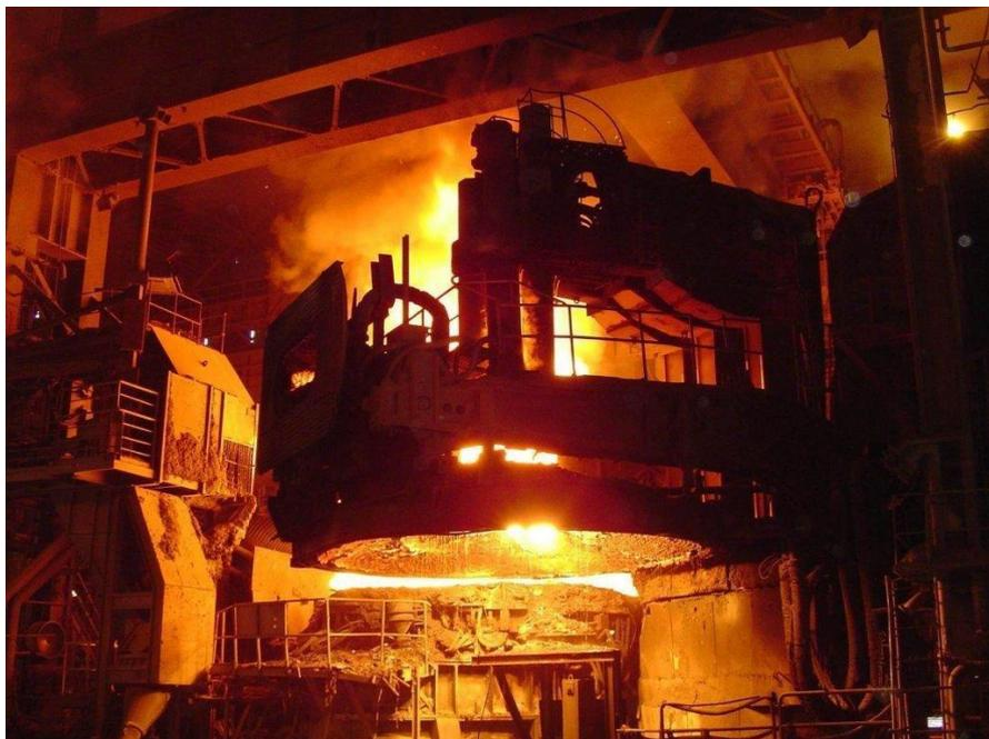
Figura 15 - Forno elétrico a Arco.
