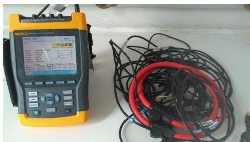
Figura 7 – Medidor de Qualidade de Energia Fluke 435.
