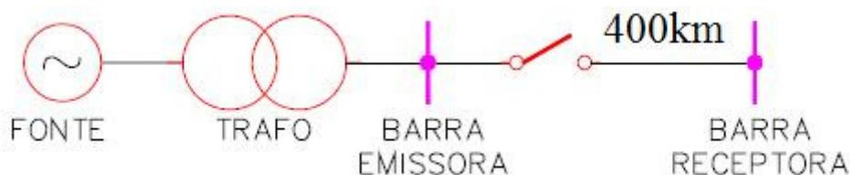
Figura 16- Sistema simplificado equivalente usado para os testes
