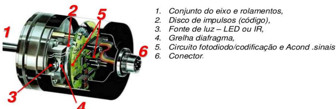
Figura 11 - Vista interna do sensor (Timóteo, 2013).
