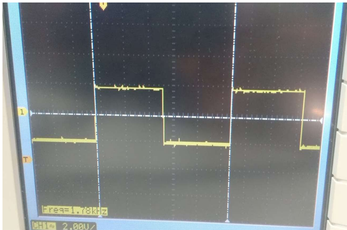
Figura 23 - Onda gerada quando o rotor é girado manualmente.
