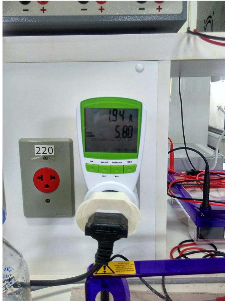
Figura 13 – Ligação entre o aparelho medidor e o refrigerador.
