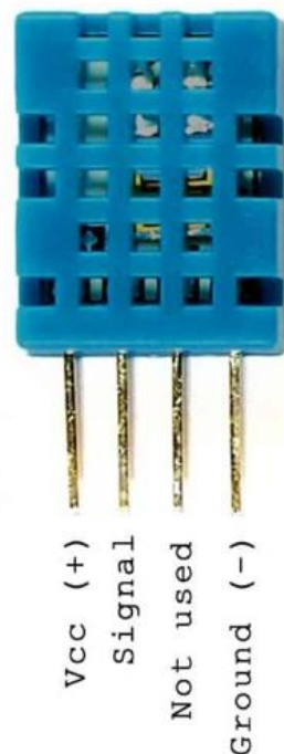
Figura 28 – Pinagem Sensor Temperatura e Umidade Dth11 [9]
