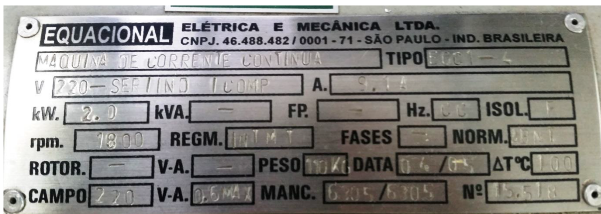
Figura 19: Placa de dados da máquina de corrente contínua.
