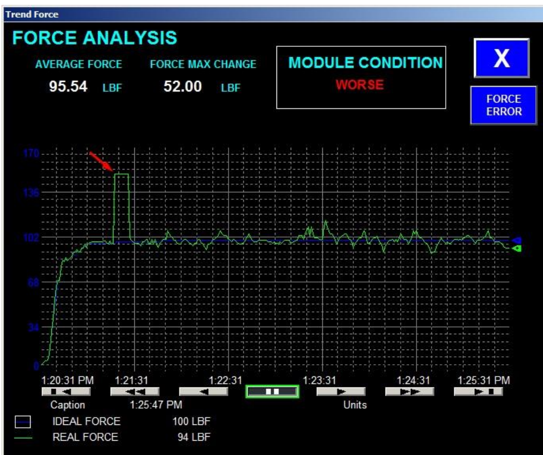
Figura 46 - Tela Trend Force – Simulação de um módulo em condição péssima (método análise do erro).
