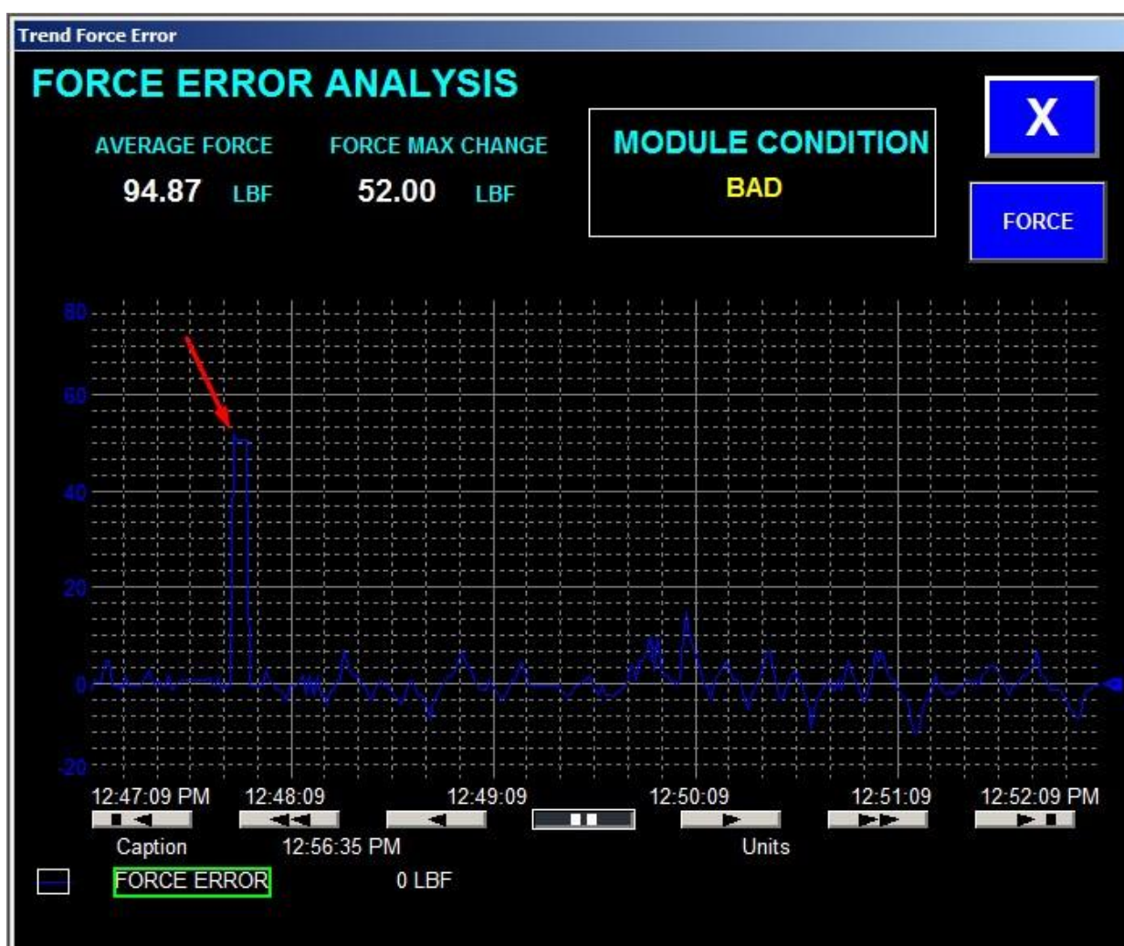
Figura 42 - Tela Trend Force Error – Simulação de um módulo em condição ruim (método análise do erro).
