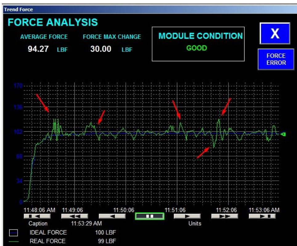
Figura 36 - Tela Trend Force – Simulação de um módulo em condição péssima (método desvio-padrão).
