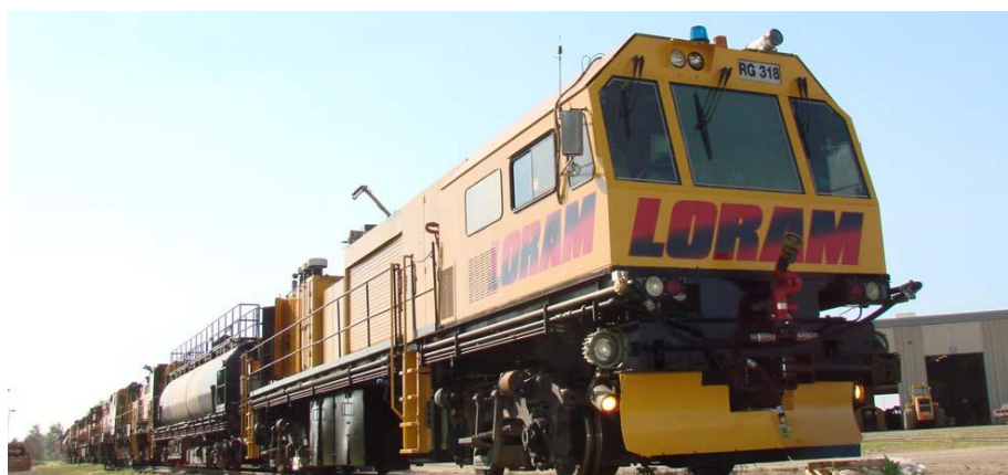
Figura 5 - Esmerilhadora de trilhos automatizada da empresa Loram Maintenance of Way Inc 1
