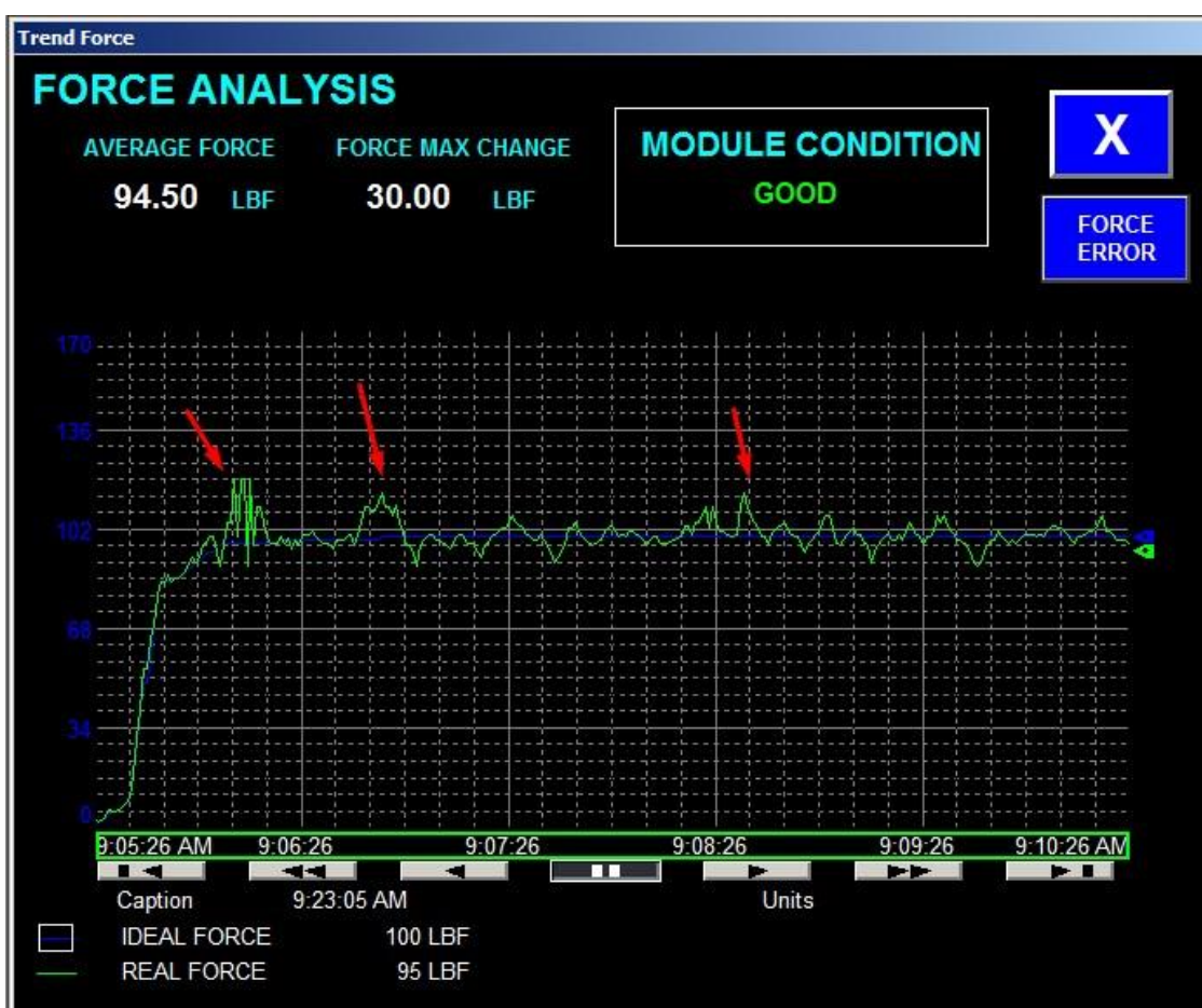
Figura 31 - Tela Trend Force – Simulação de um módulo em condição ruim (método desvio-padrão).
