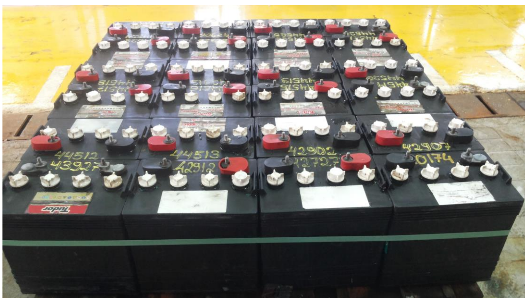
Figura 4 - 24 monoblocos da bateria Tipo 1
