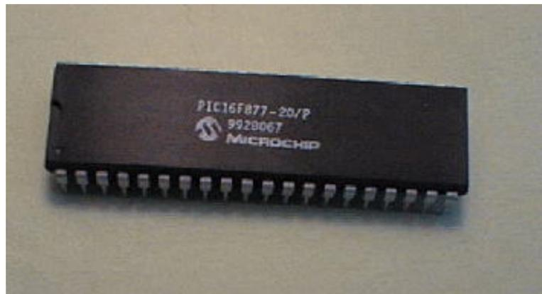
Figura 3: O microcontrolador PIC16F877
