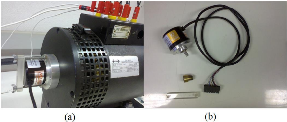
Figura 13 - a) Encoder acoplado ao rotor do motor. b) Detalhes do acoplamento mecânico.
