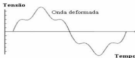
Figura 2: Onda resultante da soma da onda da tensão e da harmônica n=5
