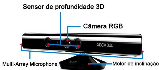
Figura 3: Componentes principais do Kinect
