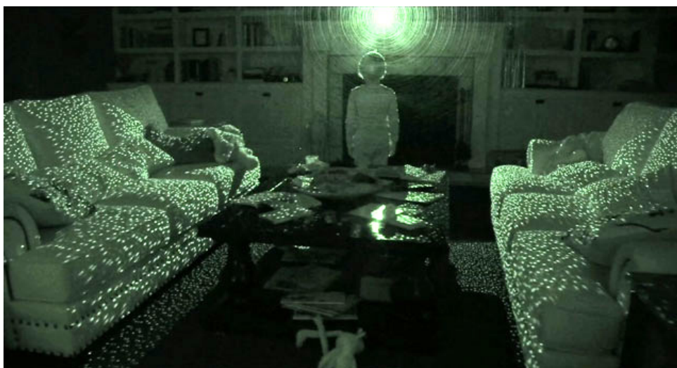
Figura 5: Luz Estruturada emitida pelo Kinect
