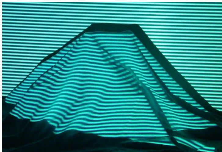
Figura 4: Exemplo de luz estruturada, com as distorções é possível calcular a profundidade
