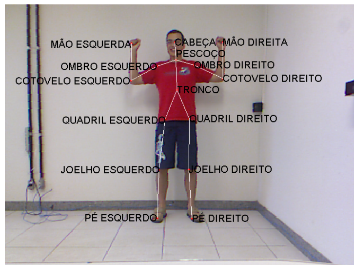
Figura 9: Rastreamento do esqueleto do usuário.
