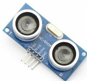
Figura 5 – Sensor de distância ultrassônico HC-SR04.
