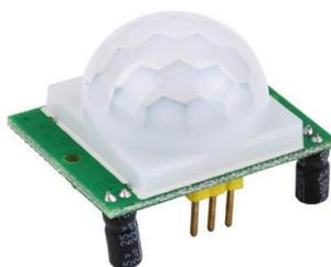
Figura 7 – Sensor de presença PIR infravermelho HC-SR501. [9]
