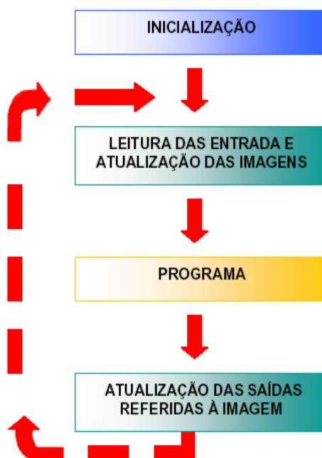
Figura 1 – Princípio do Funcionamento do CLP[6].
